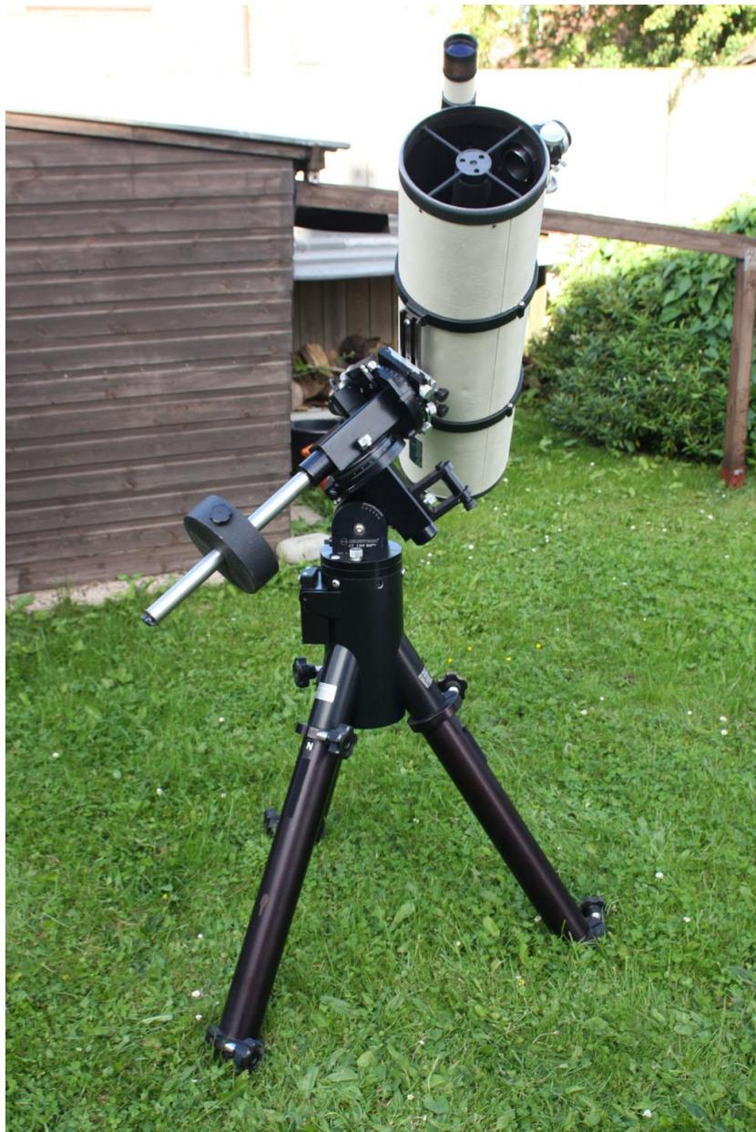
**200mm-Newton auf stabiler parallaktischer Montierung**
