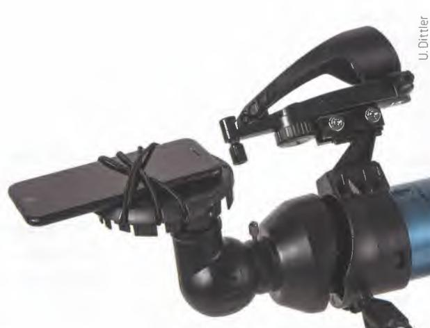
▲ Abb. 4: Der Objektivdeckel des Teleskops kann als Smartphone-Halterung verwendet werden: er kann hierzu mit der Innenseite auf das Okular gesteckt werden, so dass ein beliebiges Smartphone mittels der Gummibänder auf der Oberseite so positioniert werden kann, dass die Smartphone-Kamera direkt über dem Okular zu liegen kommt.
