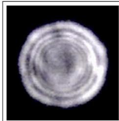
*Effekt der Luftunruhe an einem 8-cm-Refraktor.*
